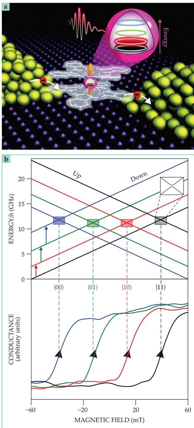
**FIGURE 3. (a) A SINGLE-MOLECULE TRANSISTOR**
